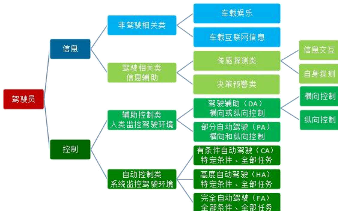
图1 智能网联汽车技术逻辑结构
